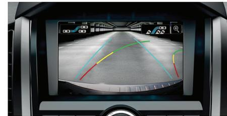
**CÁMARA TRASERA** - Aparcar en lugares muy concurridos o pequeños ya no es un problema con el sistema de asistencia con cámara trasera integrada de serie (W8-W10) y señal acústica que advierte de los obstáculos dentro de un radio de 1,20 metros
