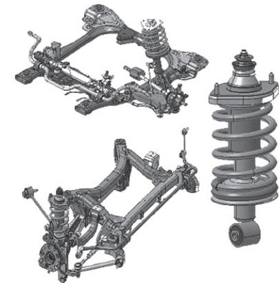
**SUSPENSIÓN** - Las suspensiones han sido diseñadas en colaboración con Lotus para un uso mixto en carretera y fuera de carretera. Para optimizar el comportamiento de Mahindra XUV500 en estas superficies tan diferentes entre sí, los diseñadores han optado por una solución de ruedas independientes - delanteras tipo McPherson, traseras Multi-link - con muelles helicoidales y barras estabilizadoras.
