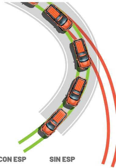
**ESP** - Es un sistema de gestión electrónica que controla constantemente los movimientos y la dirección del vehículo y, cuando detecta una pérdida de control, actúa sobre los frenos y el motor hasta restablecer la estabilidad.
