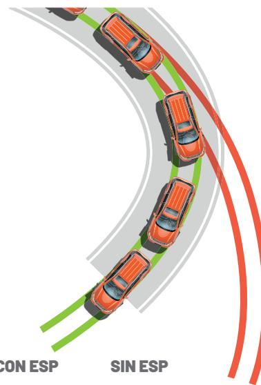
**ESP** - Es un sistema de gestión electrónica que controla constantemente los movimientos y la dirección del vehículo, y cuando detecta una pérdida de control, actúa sobre los frenos y el motor hasta restablecer la estabilidad.
