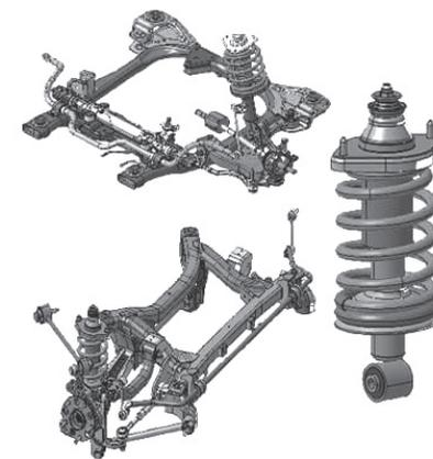
**SUSPENSIÓN** - Las suspensiones han sido diseñadas en colaboración con Lotus para un uso mixto en carretera y fuera de carretera. Para optimizar el comportamiento de Mahindra XUV500 en estas superficies tan diferentes entre sí, los diseñadores han optado por una solución de ruedas independientes - delanteras tipo McPherson, traseras Multi-link - con muelles helicoidales y barras estabilizadoras.
