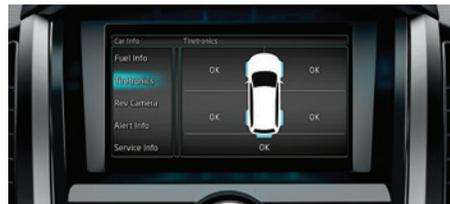
**TYRE TRONICS** - Te actualiza constantemente sobre posibles anomalías de cada neumático. Un sistema electrónico que contribuye a la seguridad y extiende la duración de los neumáticos.
